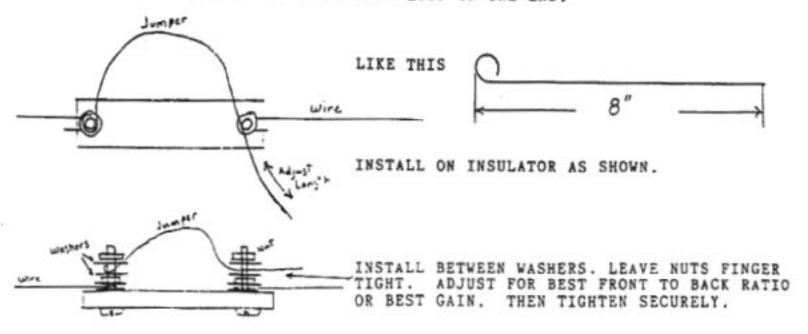
PRESET REFLECTOR MAKE JUMPERS THE FOLLOWING LENGTHS AND INSTALL ON INSULATORS AS IN STEP ABOVE.
